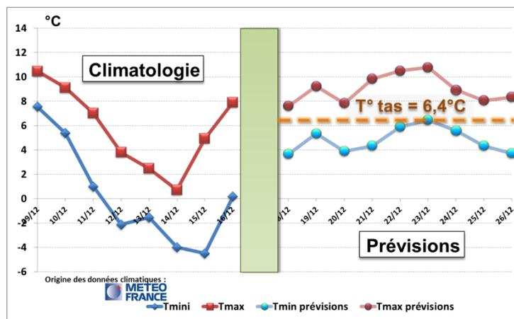
devraient rester fréquemment à proximité de la température des tas, il est préférable de maintenir un différentiel de température faible, de 1 à 1,5°C, pour garder un nombre d'heures disponibles suffisant pour la ventilation et garantir la stabilisation de la température des tas jusqu'à leur expédition, une assurance à rechercher pour que leur bon comportement actuel se poursuive. En cas de survenue d'une nouvelle phase de gel sévère,
